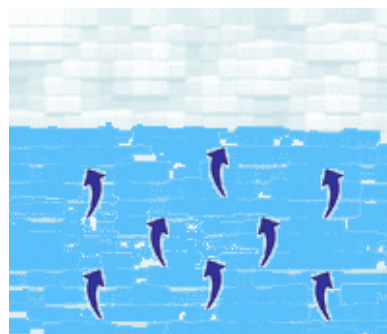
Opstigende fugt trænger op ved kapillarsugning.
